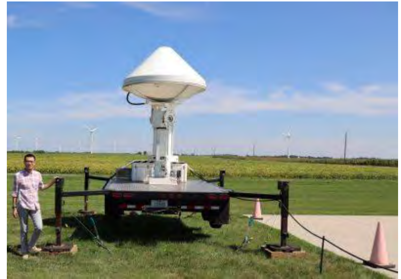
Radar Doppler a banda X e termocamere utilizzate in un impianto eolico in Iowa.
