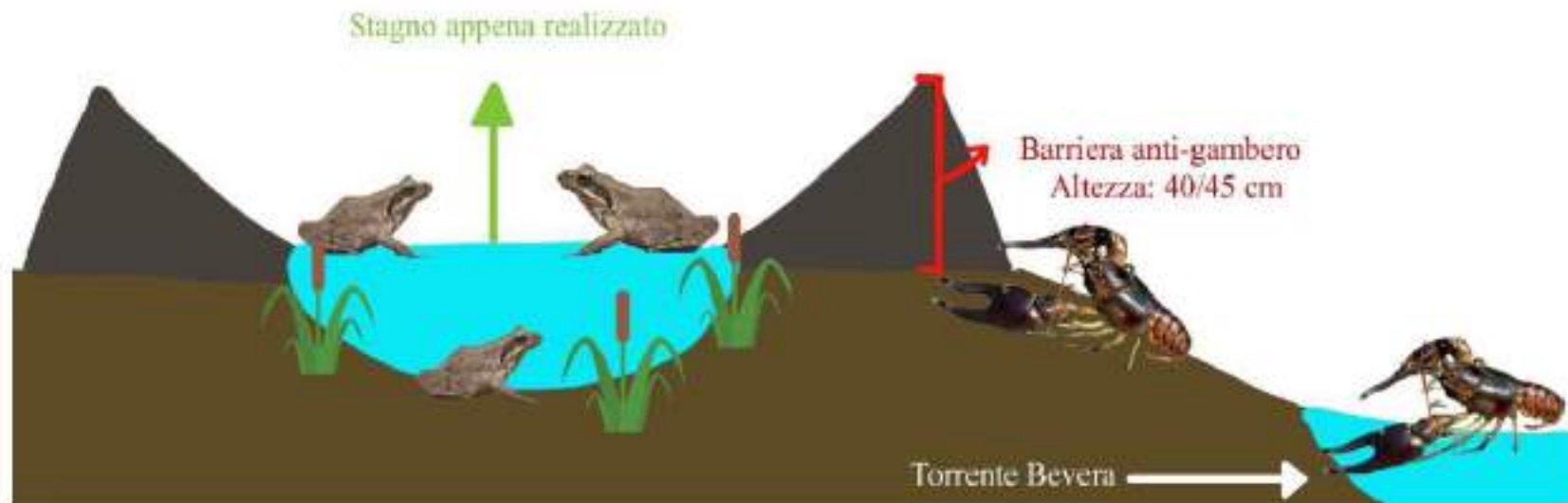
Fig. 5: schema di realizzazione della barriera antigambero in pietra attorno agli invasi
